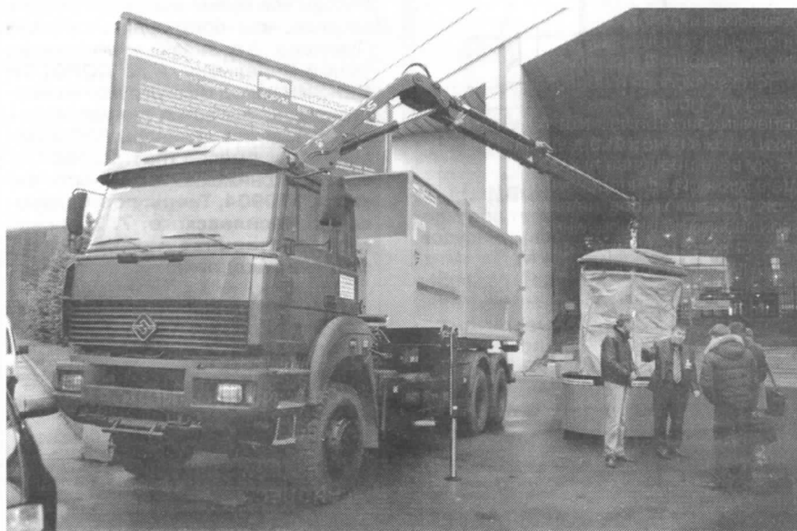
Стрела манипулятора захватывает мешок и высыпает отходы из него в кузов мусоровоза.
